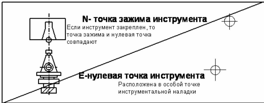
Рис. 5. Координатная система инструмента TCS
