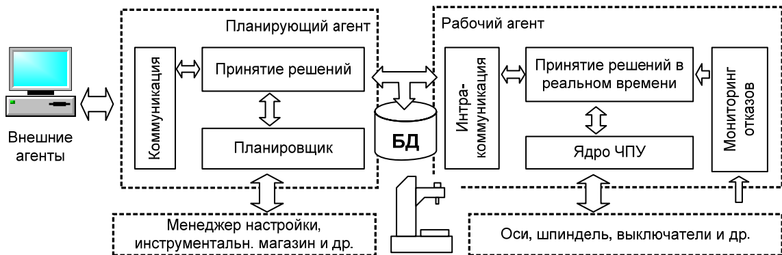
Рис. 10. Концептуальная модель интеллектуальной системы STEP-NC-CNC Человеко-машинный интерфейс, включающий подсистемы цехового программирования и моделирования обработки.
