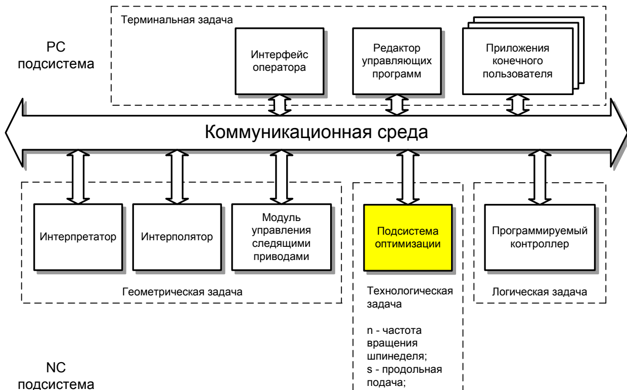
Рис. 1 Место адаптивного управления в системе ЧПУ типа PCNC
