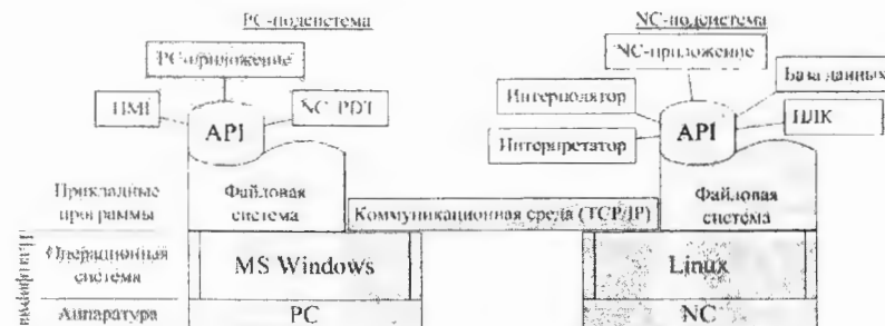
Рисунок 3 - Открытая архитектурная двухкомпьютерная система типа PCNC
