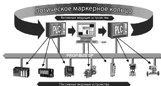
Рис. 3. Принцип работы многомастерной сети
