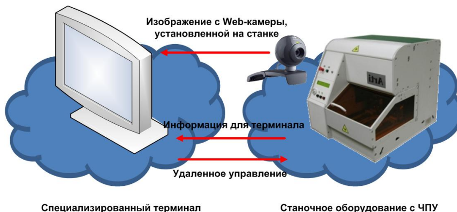
Рис. 3 - Концепция обучение с поставкой методических материалов и терминального программного обеспечения для подключения к удаленному оборудованию и принятия сигнала с Web-камеры
