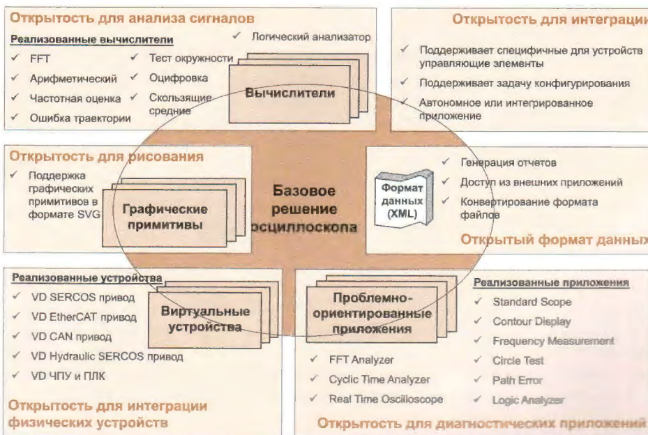
Рис. 2. Концепция реализации открытости ядра цифрового осциллографа
