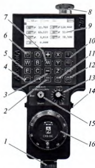
Рис. 3. Специализированный пульт ручного управления для станка мод. VMG 50: 1 — соединительный разъем; 2 — система отсчета (заготовка/станок); 3 — выбор направления перемещения оси в «плюс» или «в минус»; 4 — пуск шпинделя по и против часовой стрелки; 5 — клавиши выбора активной оси; 6 — активизация пульта управления; 7 — ускоренные перемещения (наложенный быстрый ход); 8 — кнопка аварийного останова; 9 — экран оператора; 10 — клавиши выбора инкремента (1, 10, 100); 11 — клавиша толчкового вращения шпинделя; 12 — клавиша выбора режима маховичка; 13 — корректор величины подачи осей; 14 — кнопка подтверждения включения пульта; 15 — переключатель работы с пультом; 16 — электронный «маховичок»
