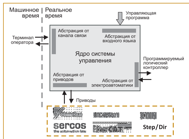
Рис. 1. Уровни абстракции ядра системы ЧПУ «АксиОМА Контрол»
