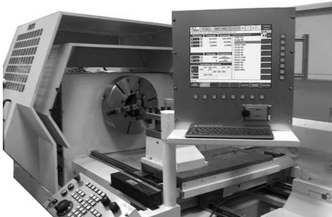
Рис. 5. Экспериментальный образец токарного станка СА700КФ2 (ОАО САСТА) с комплектной системой управления (МГТУ «Станкин»)
