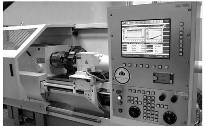
Рис. 6. Модернизированный станок 16A20 с диагностическим комплексом, интегрированным в систему ЧПУ
