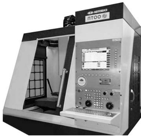
Рис. 4. Экспериментальный образец фрезерного обрабатывающего центра МС-400 (ПТОО АвтоВАЗ) с комплектной системой управления (МГТУ «Станкин»)
