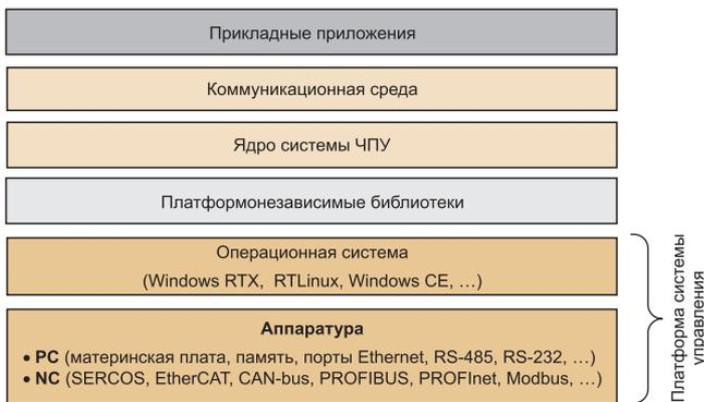
Рис. 1. Виртуальная модель кроссплатформенной системы ЧПУ
