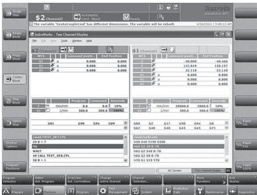
Рис. 1. Экран оператора для управления двух каналов системы ЧПУ MTX (Bosch Rexroth)
