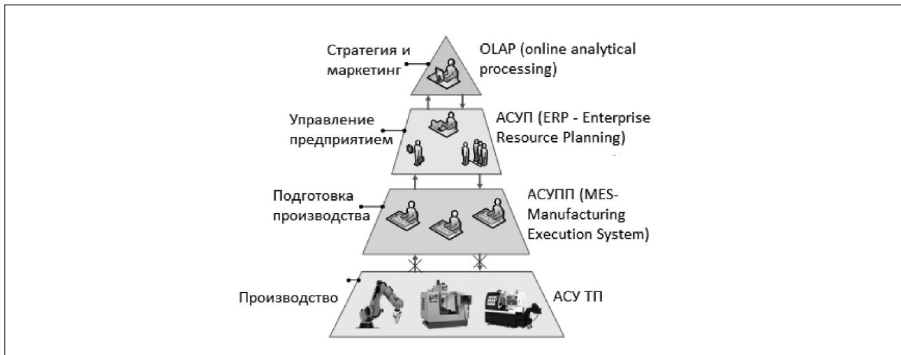
Рис. 1. Уровни построения современного цифрового производства
